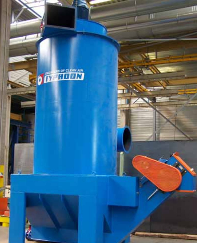
HYDROCYCLOON MET UITHAALSYSTEEM VOOR HET AFSCHEIDEN VAN METAALSTOF
