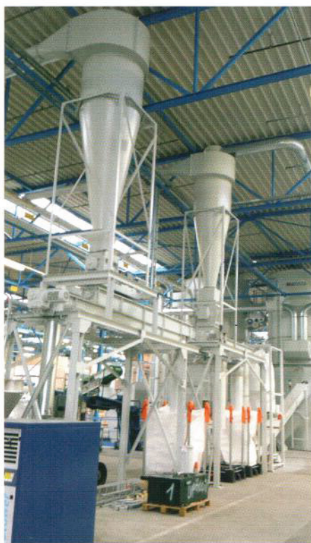
Afb. 2 Twee cyclonen die door Typhoon zijn geïnstalleerd. Een voor de afscheiding van schuurstof; de ander voor de recyclaatfractie
